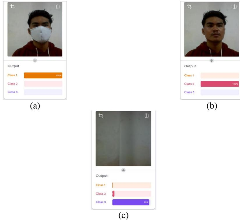
Gambar 5. Pengujian Pendeteksian Masker Terhadap Perubahan Jarak pada (a) Kondisi 1, (b) Kondisi 2, (c) Kondisi 3
