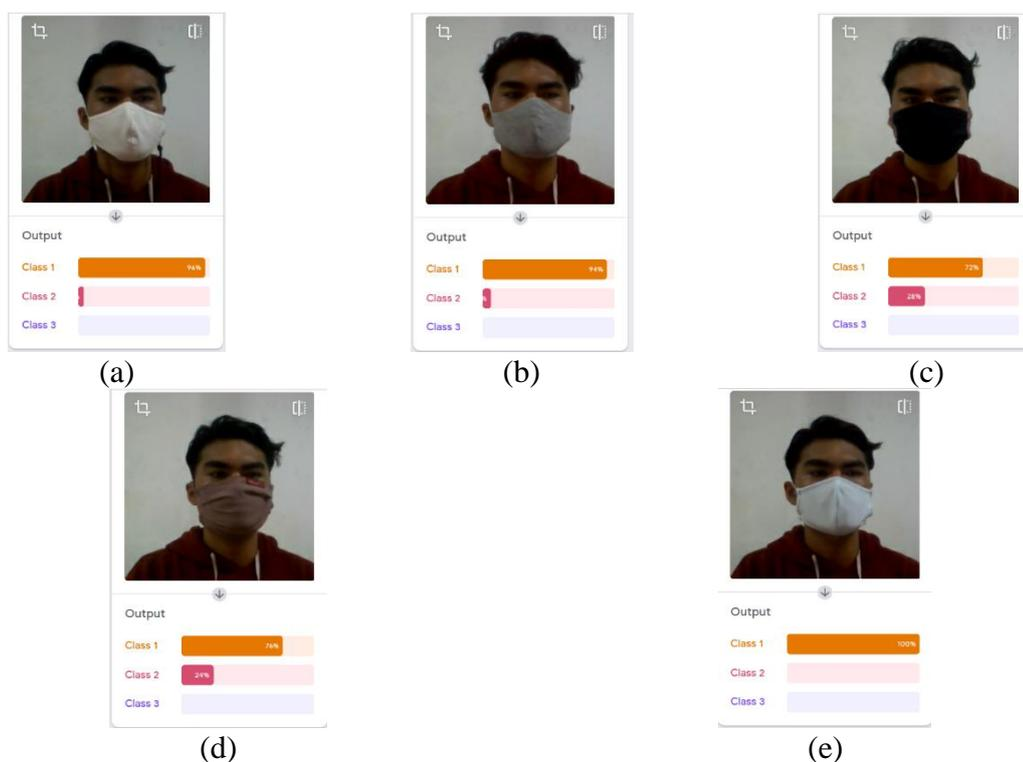
Gambar 7. Pengujian Pendeteksian Masker Terhadap Perubahan Warna Masker dengan Warna (a) Putih, (b) Abu-Abu, (c) Hitam, (d) Coklat, (e) Hijau. (Sumber: Dokumentasi, 2021)
