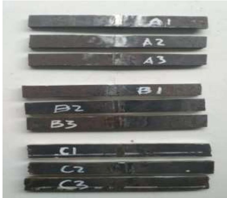
Gambar 4. Bentuk spesimen menurut ASTM D790-02.
