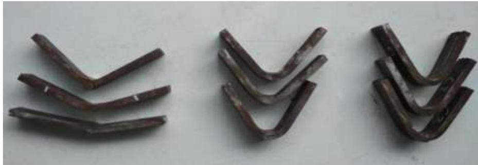
Gambar 8. Hasil spesimen uji bending
