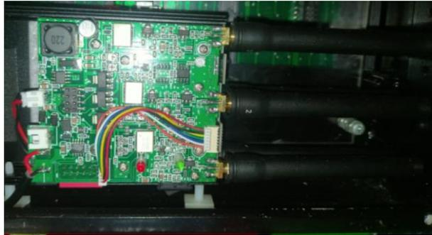
Gambar 1. Bentuk Fisik Rangkaian *Jammer*
