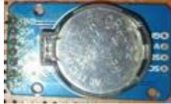
Gambar 3. Bentuk Fisik Dari RTC DS3231
