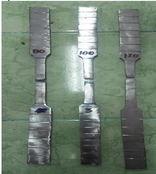
Gambar 4.1 Spesimen Hasil Uji Tarik
