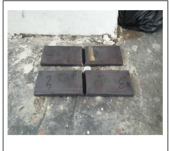
Gambar 3.2 Spesimen Kampuh v
