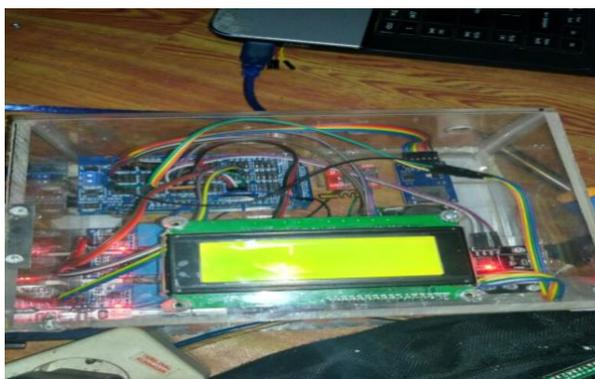
Gambar 3. Rancangan alat *monitoring* kapasitas daya listrik.
