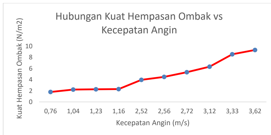
Gambar 10. Grafik Hubungan Antara Kuat Hempasan Ombak dan Kecepatan Angin
