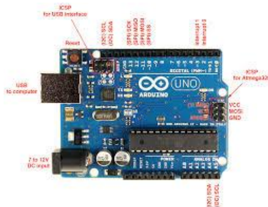
Gambar 2. Arsitektur Arduino Uno
